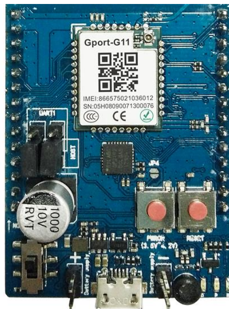
Gport-G12 EVB, 板子上有两路天线, 上面一路是 GPRS 天线, 下面一路是 GPS 天线。
